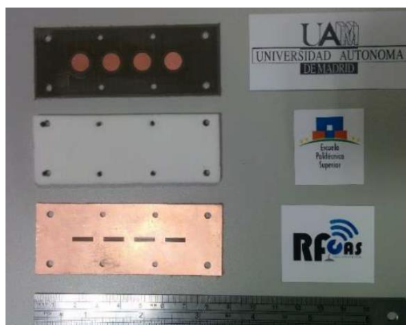
Figura 6- 3 Elementos radiantes: parches, foam y ranuras, extraído de [2]
