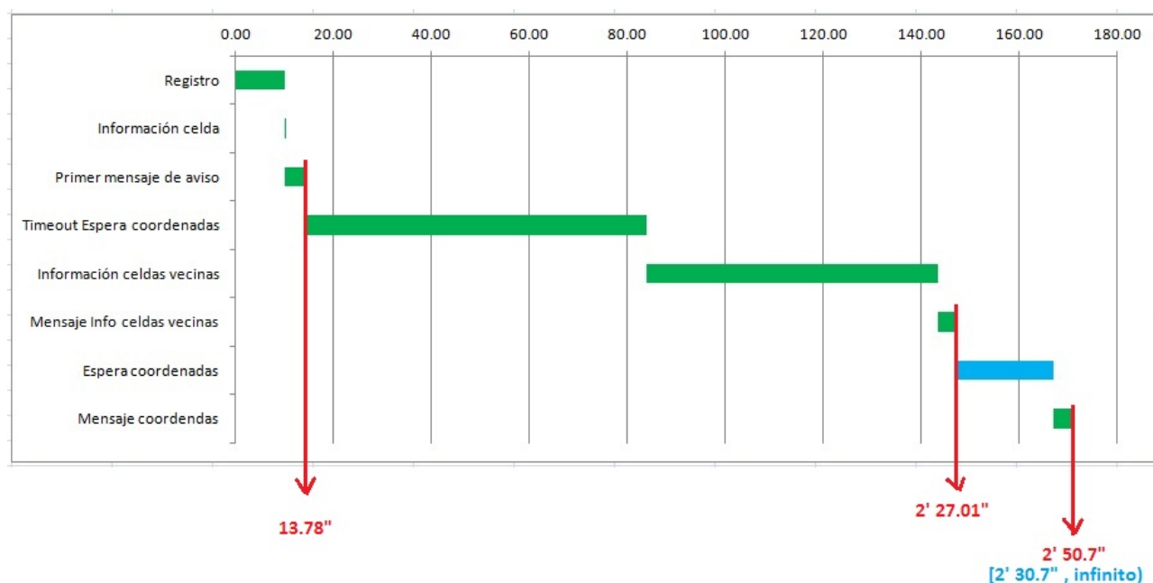
Figura 4.56: Cronograma con timeout GNSS del dispositivo final.
