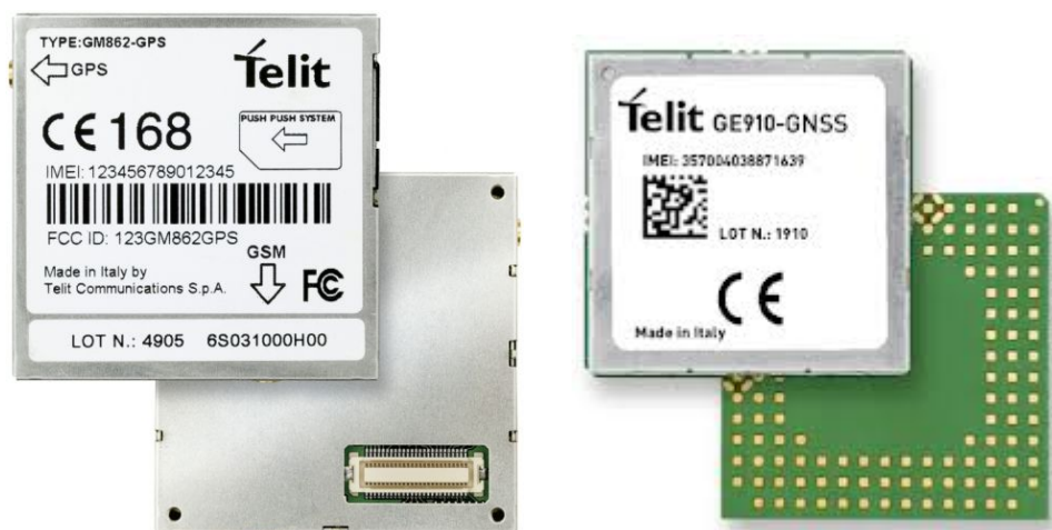
Figura 4.1: Módulos GSM (con GNSS embebido) candidatos para el diseño final.
