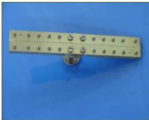
**Figura 2-5: Array lineal de ranuras para banda**
