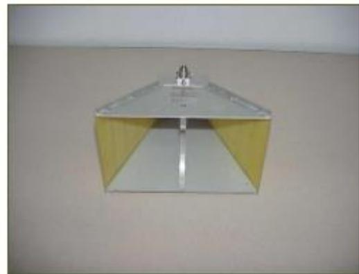
**Figura 2-9: Antena de bocina de 1 a 18 GHZ**
