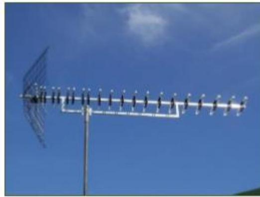
**Figura 2-4: Antena UHF de 22 elementos para TV digital**
