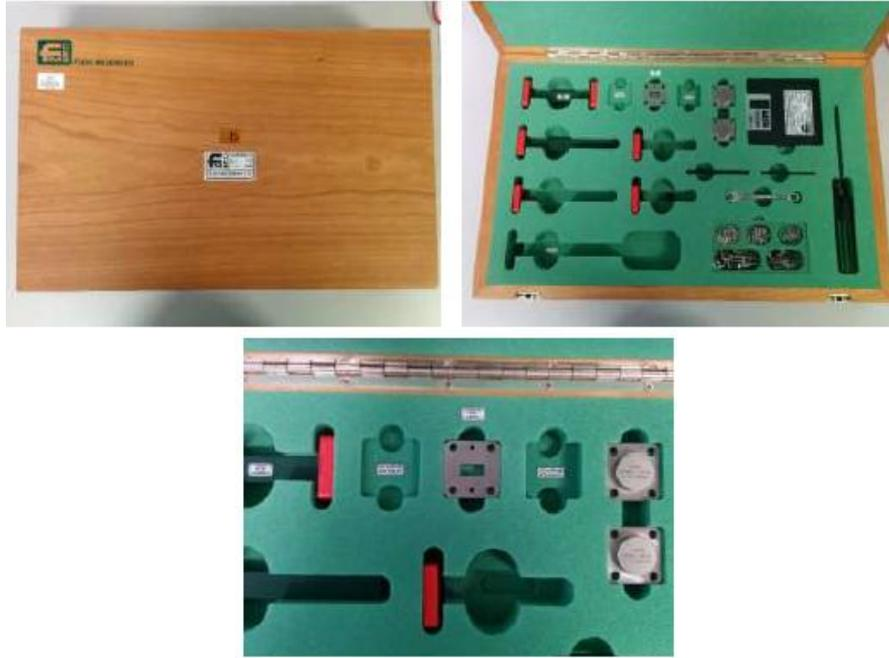
**Figura A - 2 Kit de calibración Flann Microwave LTD Calibration Kit 19703**
