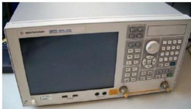
**Figura A - 1 Analizador de redes Agilent E5071C propiedad de la EPS**
